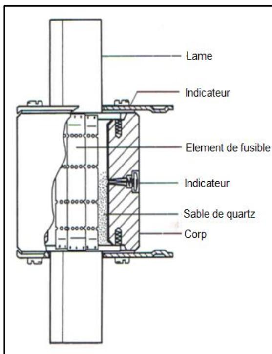
La gamme des fusibles NH00C avec les caractéristiques de fusion gG taille 00 est disponible avec des intensités de courant nominales de 50A à 1600A.
